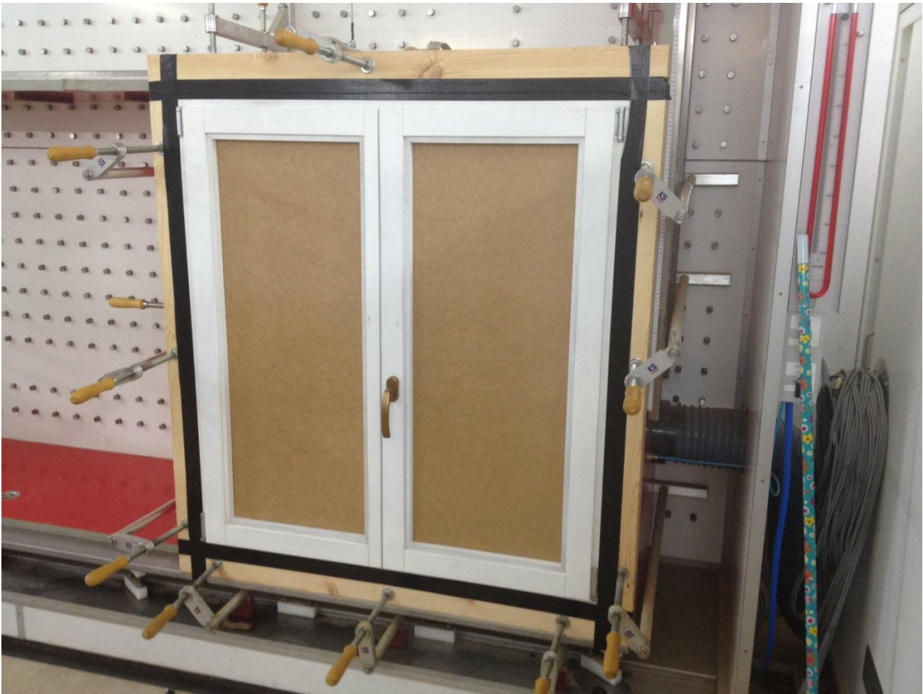
Imagen 1. Ventana+premarco colocada en banco de ensayos.
